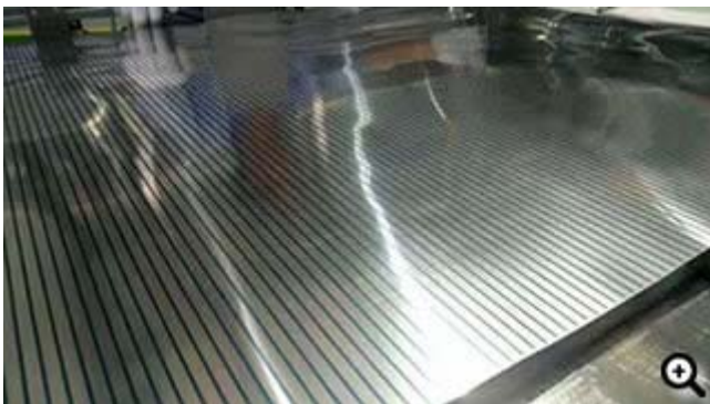
接着工程後のハニカムブロック
