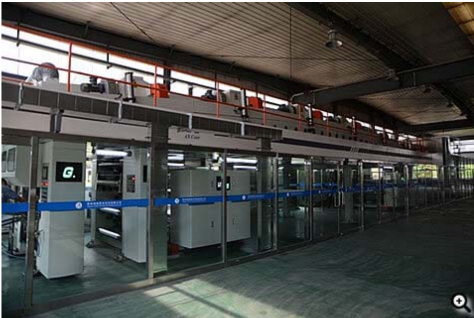
アルミハニカム新規生産ライン全景 ハニカムコア生産世界最速ライン 環境温度を常時一定に保ち、高い品質を維持・管理
